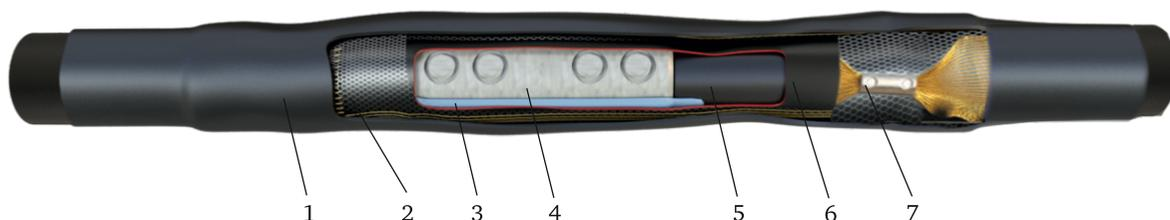
Муфты 1 ПСТ-10 предназначены для соединения 1-жильного кабеля с изоляцией из сшитого полиэтилена на напряжение до 10кВ.
