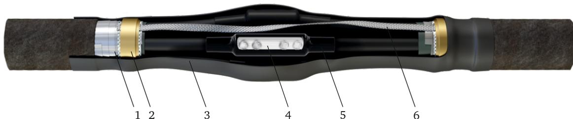
Муфты ПСТ6 нг-LS, не поддерживающие горение (нг), с низким выделением дыма (LS) предназначены для соединения 4-5 жильных силовых кабелей с пластиковой и ЭПР изоляцией с броней, на напряжение до 1 кВ. Данные муфты устанавливаются как в земле, так и на воздухе на вертикальных и других кабельных трассах.
